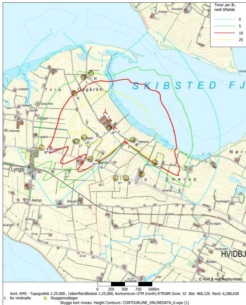
Figur 12.3: Beregnet reelt antal skyggetimer pr. år ved opstilling af 3 stk. Siemens SWT-DD-130.
