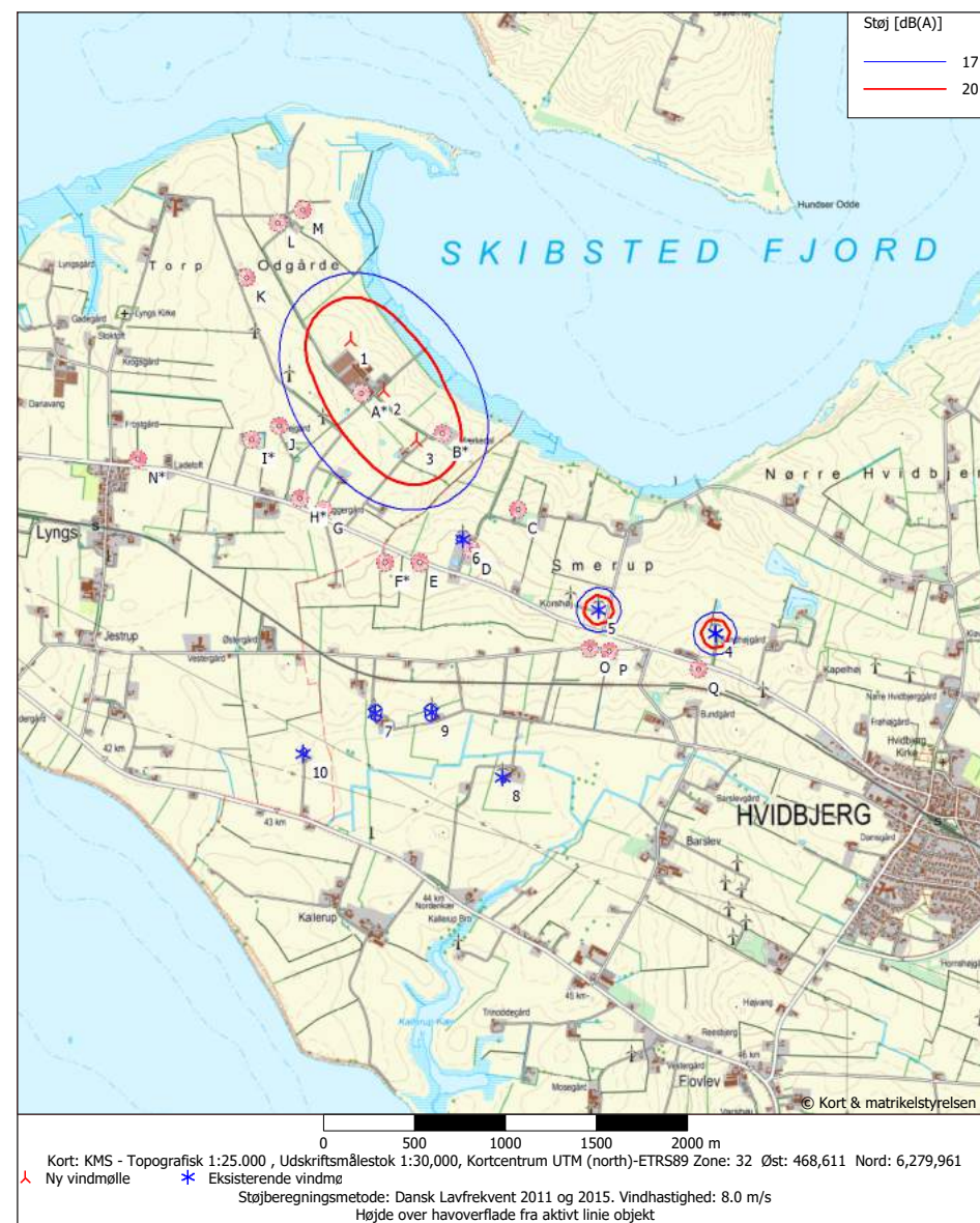
Figur 11.14: Beregnet lavfrekvent støj ved 8 m/s for SWT-DD-130. Den røde streg angiver støjgrænsen og dermed det område, hvor udenfor naboboliger og støjfølsomme arealer skal ligge.
