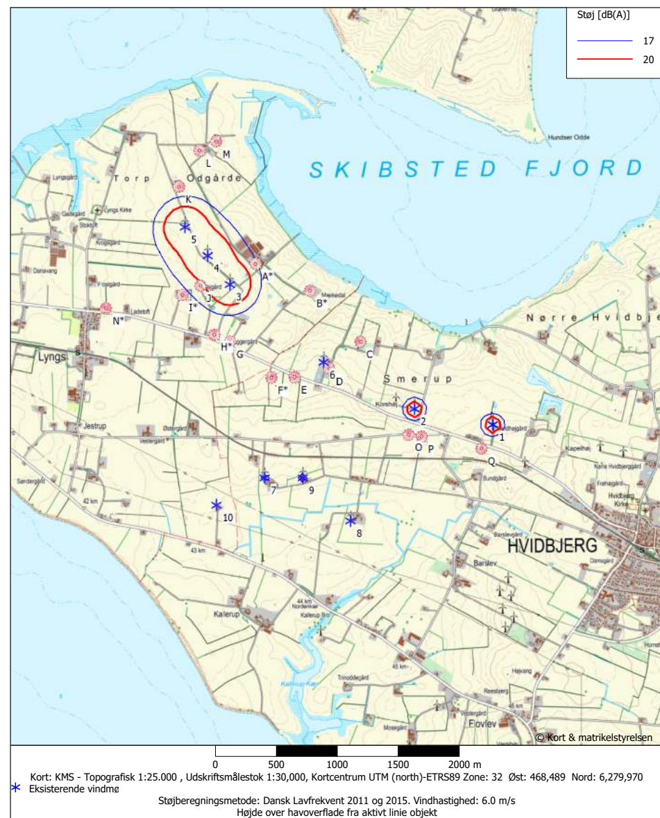
Figur 11.5: Beregnet lavfrekvent støj for den eksisterende situation ved 6 m/s.
