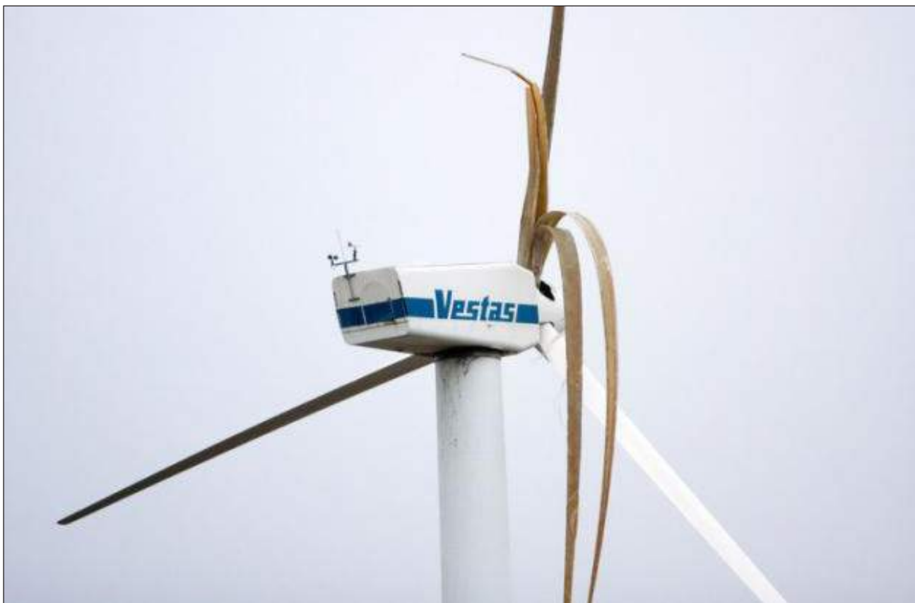
Figur 4.7 Ældre vindmølle på Mors ramt af lyn i møllevingen, kilde: mf.dk
