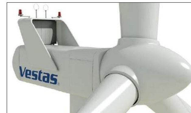
Figur 4.2 Lysafmærkning på Vestasmølle, kilde: Vestas.com
